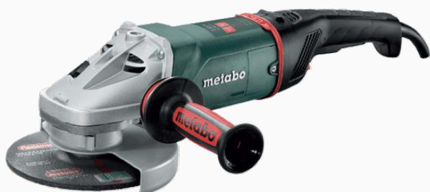
Motor Marathon de Metabo con protección contra polvo patentada para una larga vida útil. El interruptor de seguridad de Metabo evita una conexión involuntaria. Cubierta protectora regulable sin necesidad de herramientas; se puede fijar protegida contra torsión. VibraTech (MVT) de Metabo: sistema amortiguador integrado y empuñadura adicional para reducir las vibraciones para proteger la salud.
