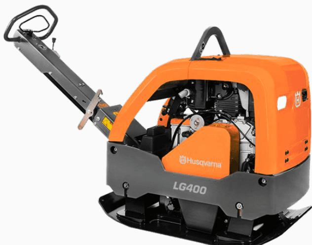
La LG 400 26" es una imponente plancha compactadora reversible de 398 kg, potente y fiable, que se ha desarrollado para ofrecer una compactación eficaz en suelos granulares de espesor intermedio a alto. Es una máquina eficaz que sirve como alternativa o complemento de los rodillos en trabajos de compactación en espacios reducidos, con un rendimiento de 975 m<sup>2</sup>/hora. Cuenta con un diseño ergonómico y fácil de mantener.
