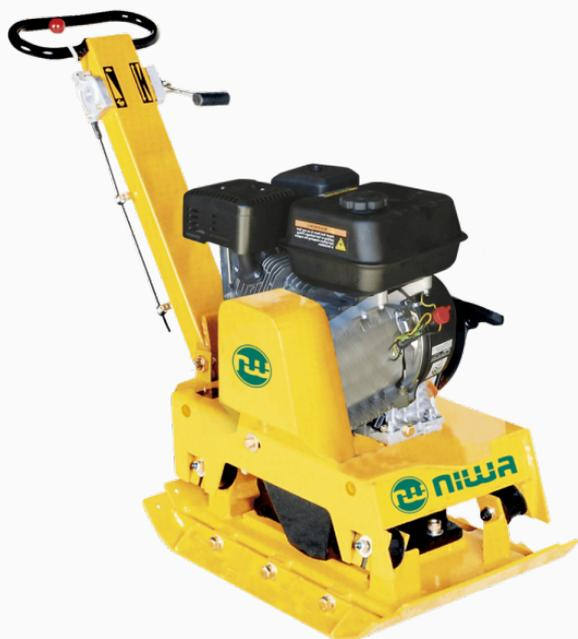
La plancha reversible con motor Robin de 5,7 HP, puede avanzar y retroceder gracias al doble excéntrico. Con 160 kg de peso , se usa para compactar hasta 0,50 m de espesor de suelo
