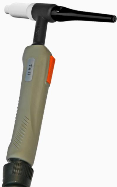
Torcha TIG de 150 amp tipo WP 17, con mango ergonómico y pulsador incorporado, 4 metros de largo. Ficha con de 2 pin de conexión. Para soldadora Niwa TIG Pulse 200.
