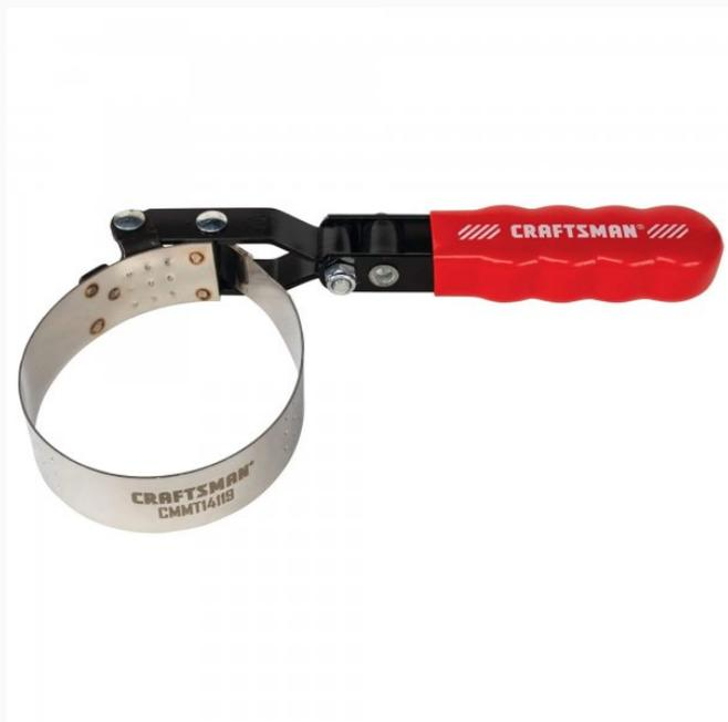
La Llave para Filtro de Aceite de 2-7/8 pulgadas a 3-1/4 pulgadas tiene un mango de agarre cómodo que permite al usuario pivotar para acceder a esos filtros de difícil alcance. La tensión giratoria se ajusta fácilmente en el mango. El ensamblaje único de horquilla y enlace proporciona un agarre firme sin aplastar el filtro. La banda de acero de ajuste automático tiene muescas para una mayor potencia de agarre.
