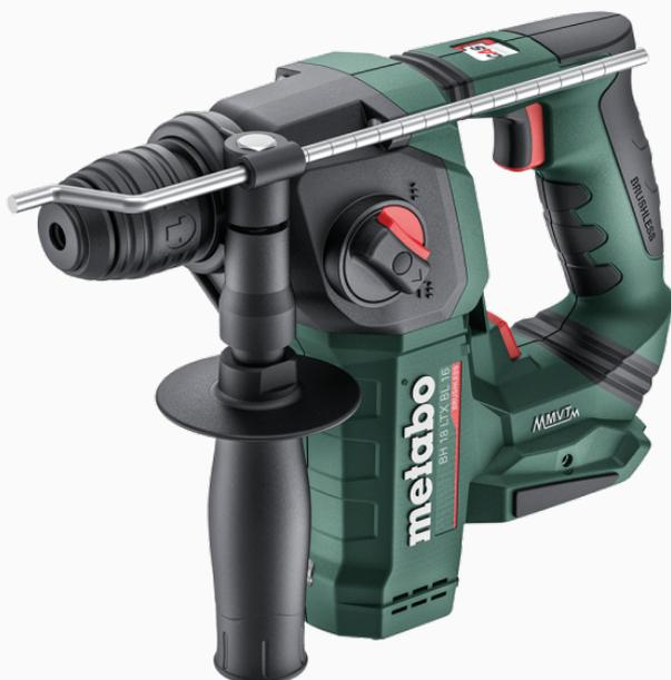
Martillo a batería 18 V compacto. Rendimiento profesional (1,3 Joule), tecnología Brushless, electrónica constante, para trabajos de bajo esfuerzo (por ejemplo, aplicaciones por encima de la cabeza. Con embrague electrónico para un trabajo seguro incluso con el manejo con una sola mano. Mango antivibratorio para trabajo continuo. 16 mm máximo de perforación en hormigón. Metabox 145 L
