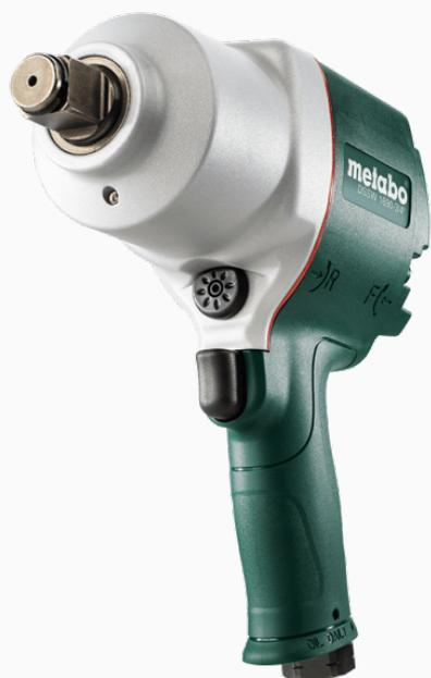
Llave de impacto neumática con encastre de 3/4", robusta, cómoda con agarre ergonómico revestido en goma. Entrega 1100 Nm de ajuste y 1690 Nm de desajuste, para aplicaciones tales como ajustar/desajustar bulones o tuercas de rueda en vehículos o maquinas agrícolas, para montaje de estructuras y reparaciones en general. Torque con regulación en 3 posiciones.
