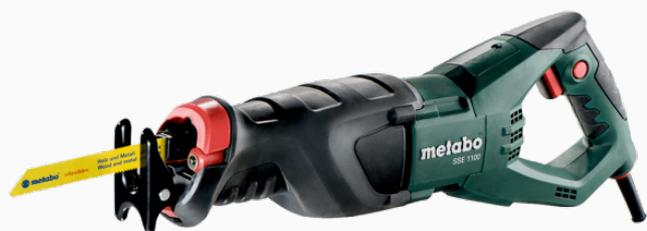
Sierra sable de 1100 W compacta y potente con 4mts. de largo de cable, interruptor de aceleración con bloqueo para un trabajo continuo. Empuñadura antideslizante softgrip, cabezal de sierra con giro a 180° y sistema de cambio de herramienta rápido sin necesidad de ninguna llave.
